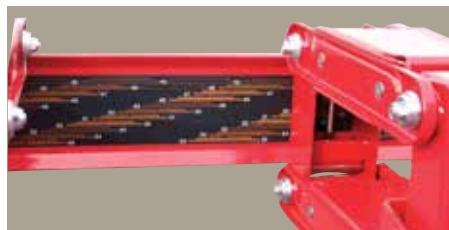
Nastavovací stupnice pro nastavení řádkové rozteče.
