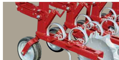
Nastavení hloubky pomocí vřetenového mechanismu
