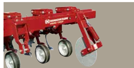
Stabilizační řídicí kotouč zatížený pružinou
