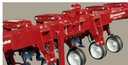
Spojovací konzole jsou nastavitelné nezávisle na sobě.
