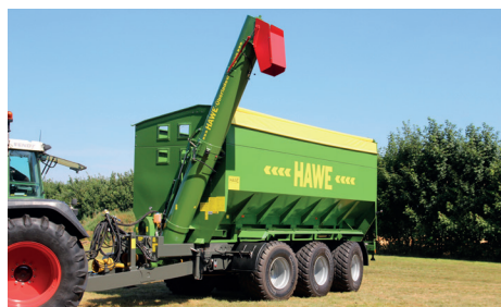
Hydraulicky sklopný vyskladňovací šnek pro vysokou výkonnost
