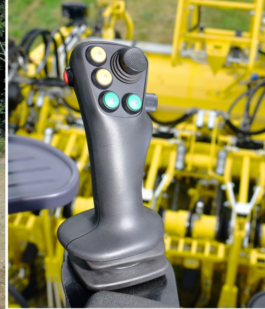
Ovládací prvek na levé loketní opěrce pro citlivé ovládání vyprazdňování bunkru
