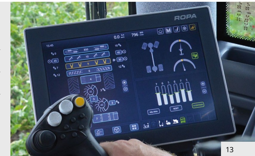
Automatické nastavení hloubky radlic na nerovném terénu Ultrazvukové senzory vedle každého řádku řepy detekují povrch půdy
