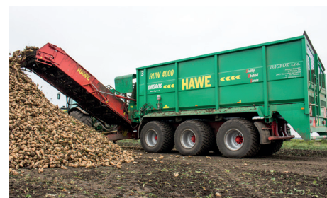
Výkonný hydraulicky sklopný dopravník o délce 4,5 m
