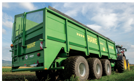
Rozměrné pneumatiky snižují potřebu tažné síly a zabraňují utužování půdy
