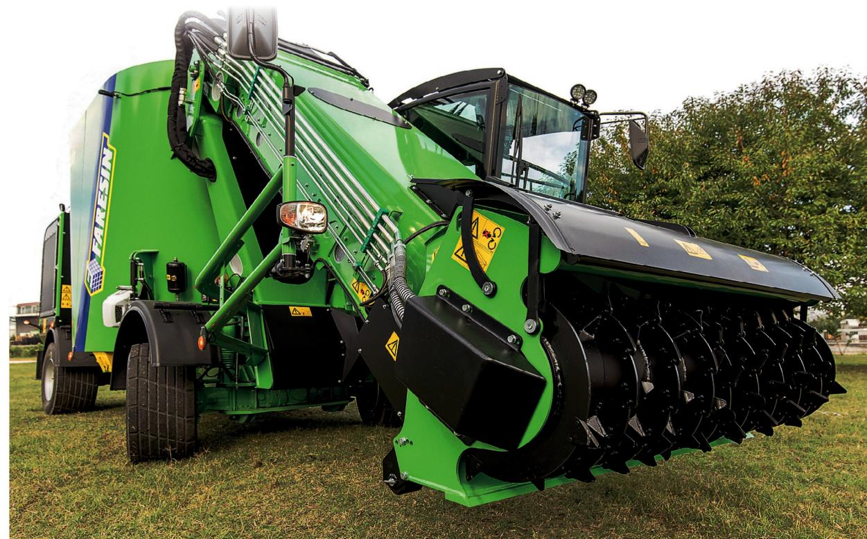
*Na rameni frézy může být na přání i štípač slámy, jak je tomu i u krmného vozu v Trstěnicích. Protostří je nastavitelné a sláma může být nařezána na požadovanou délku*
