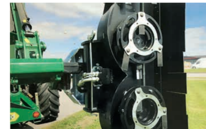
RM 232 má 4 rotory, na každém jsou 4 nože. Nižší položené nože materiál stříhají a výše uložené nože materiál drtí.
