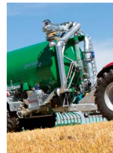
Nasávací ramena se dvěma otočnými klouby
