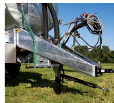
Hydraulické nucené řízení
