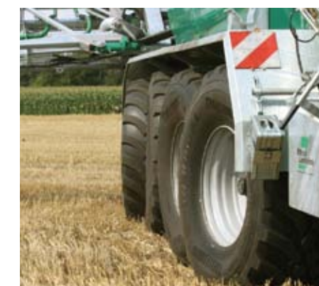
MultiSteeringSystem (MSS) – všechny nápravy jsou řízeny
