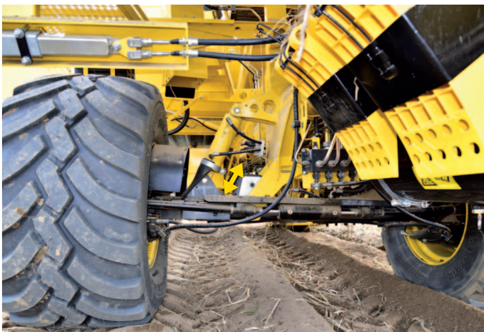
Automatické hydraulické vyrovnání sklonu
