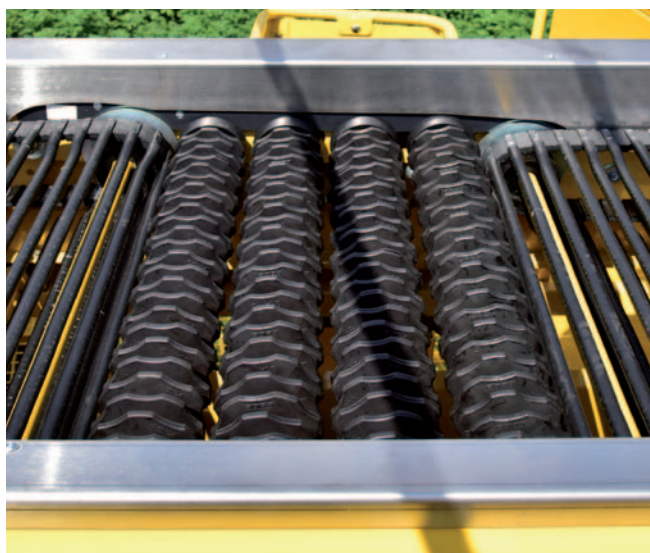
Třídící válce, plynule nastavitelné od 25 do 40 mm
