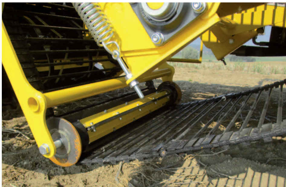
Upínač filtračního řetězu s integrovaným čistícím válcem
