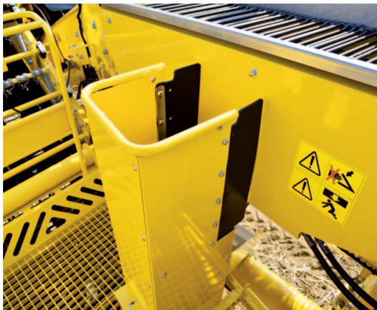
Vysoce dimenzované oddělovací šachty
