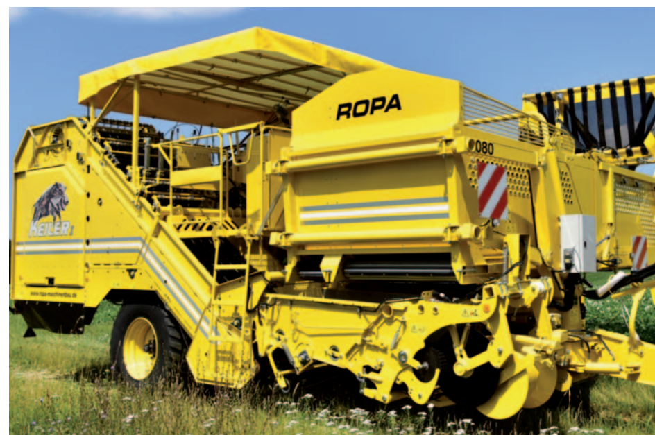
Stříška proti slunci (na přání, lze rozšířit o boční kryt)
