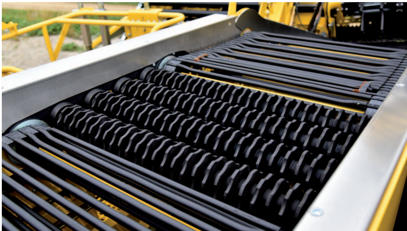
Třídící válce, plynule nastavitelné od 25 do 40 mm
