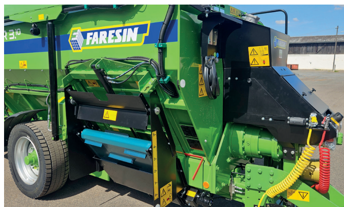
Vyprazdňovací pásový dopravník je umístěn vpravo.
