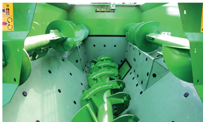
Krmný vůz lze na přání vybavit plastovou nebo nerezovou výstelkou.
