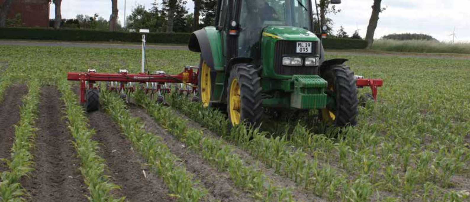
Štroj VCOF 8-76 v kukuřici. Kamera snímá 3 řádky.
