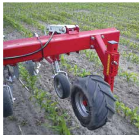
Podpěrná kola s velkým traktorovým vzorem zajišťují stabilní a přesnou polohu nosníku.
