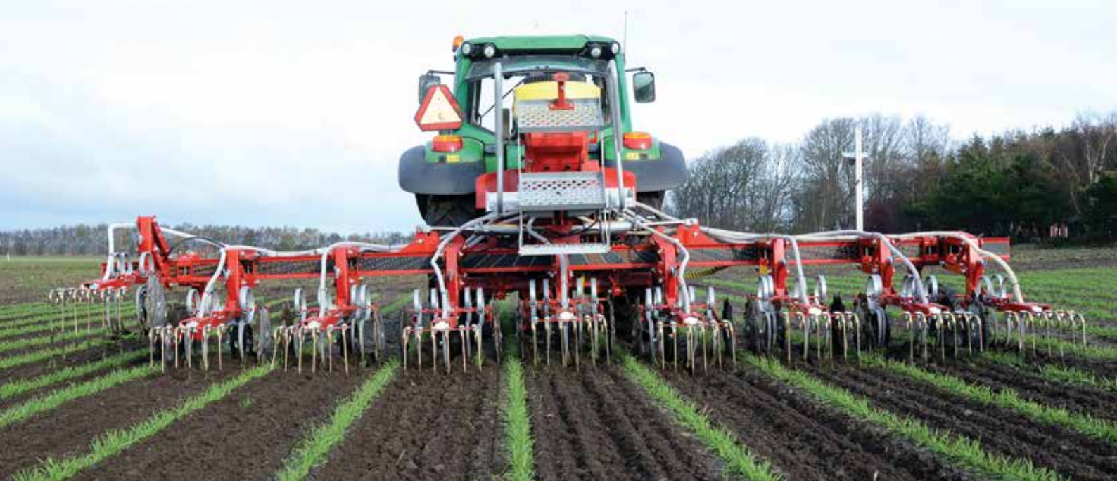
Stroj VCOF 8-75 s řízením segmentů – vnější segment vlevo je zdvižený.
