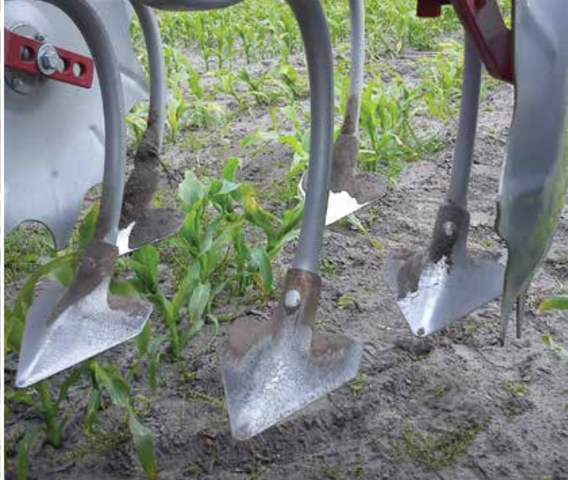
Čistící segmenty - slupice a radličky Kongskilde, otočné disky na ochranu plodin.
