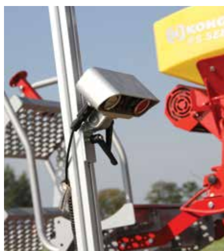
Výšku a úhel natočení stereo kamery je možné nastavit v závislosti na momentálním stadiu růstu plodiny.
