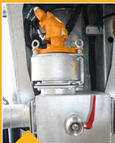
Vzhledem k umístění Turbo plniče vespod cisterny, je ho možné využít pro pravé a levé šoupě (případně sací rameno), aby se dosáhlo co nejkratší doby plnění.
