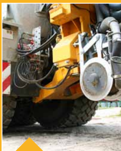
Dvojitý vysoce kvalitní závěs umožňuje zapojení široké palety aplikátorů.
