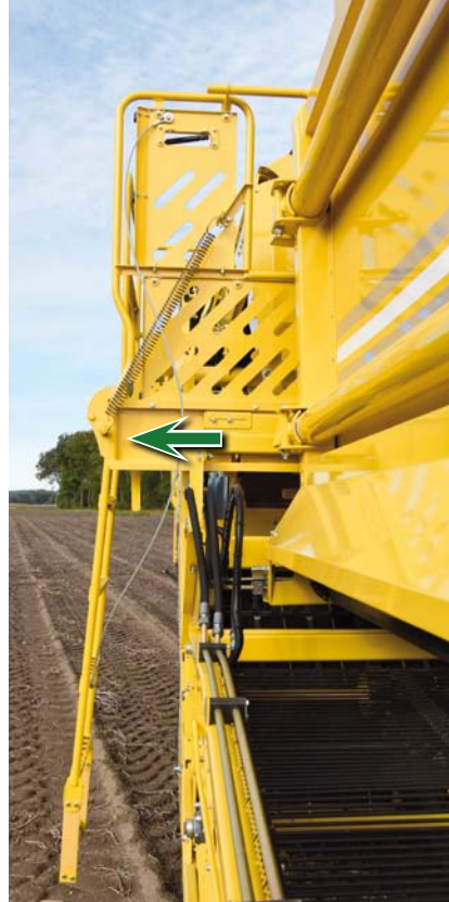
Pracovní podlaha, 300 mm výsuvná - velkorysá pracovní plocha pro větší volnost pohybu
