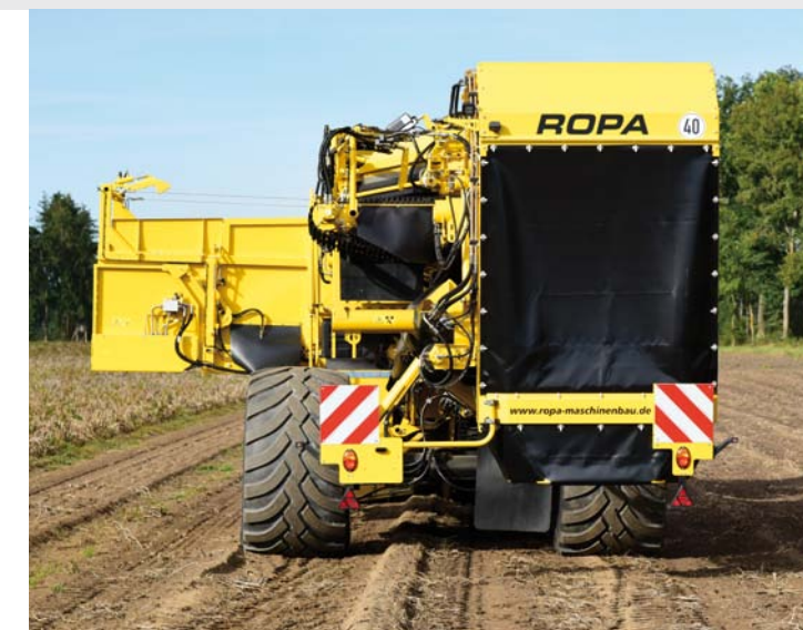
Standardní hydraulická kompenzace sklonu - optimalizované čištění a větší pohodlí pro přebírací personál
