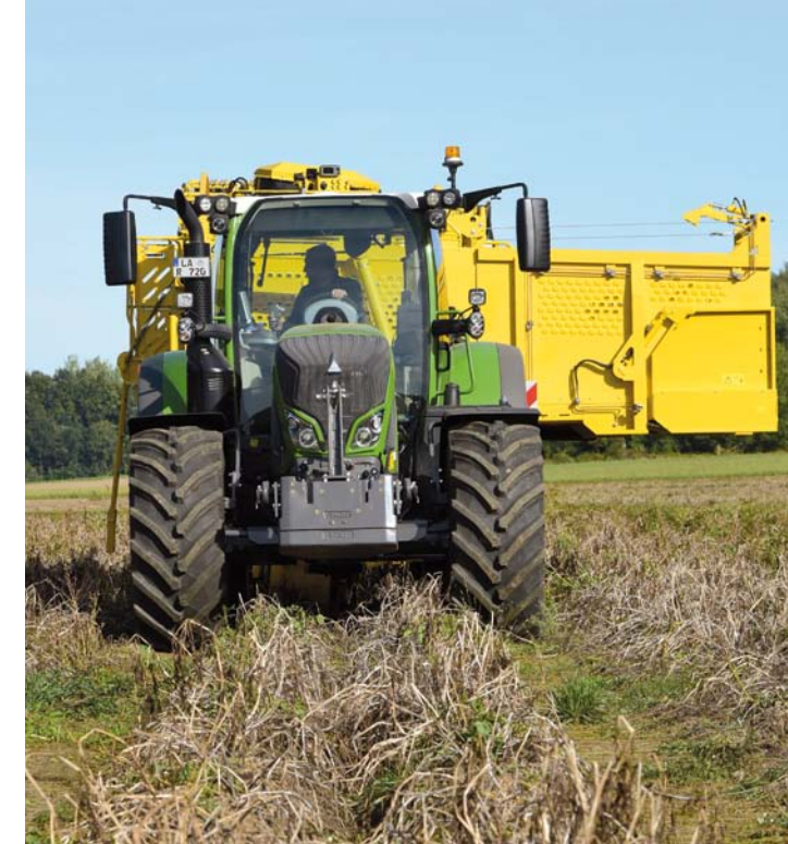
Vyorávání kolejových řádků se zasunutou teleskopickou nápravou - bez jízdy po hrůbkách brambor
