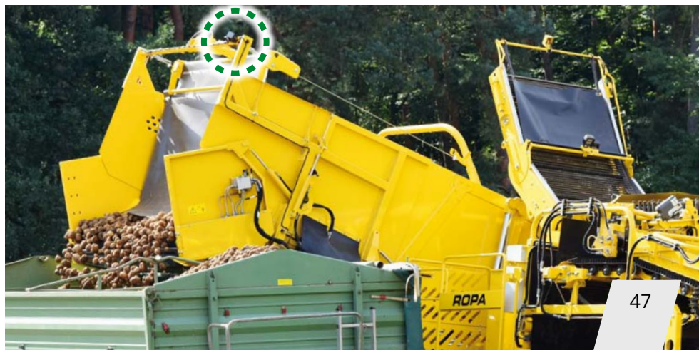
Přídavné kamery pro prosévací pás, vynášec natě, ježek, přebírací pás, zásobník a pro zpětný chod stroje
