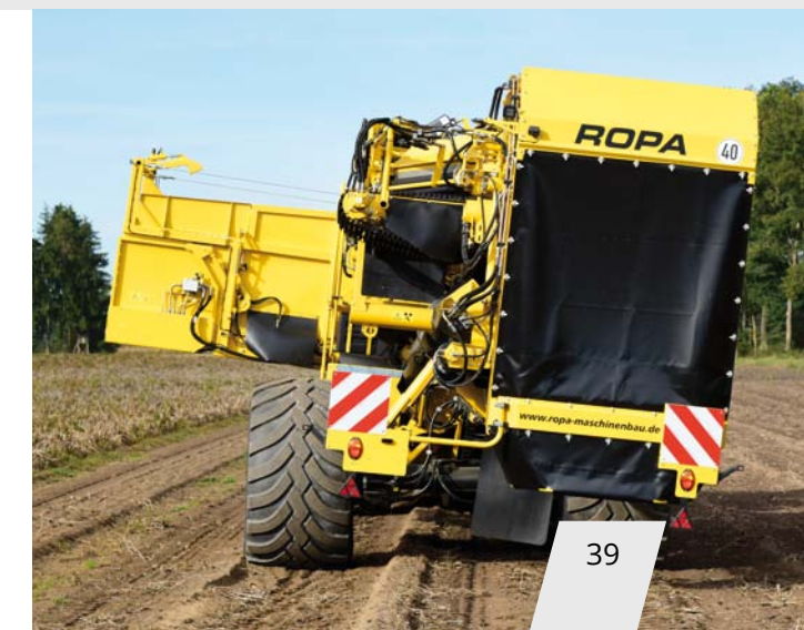
Standardní hydraulická kompenzace sklonu - optimalizované čištění a větší pohodlí pro přebírací personál
