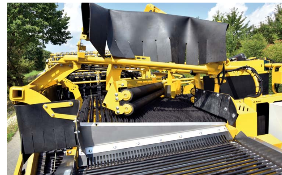
Keiler 2 4-ježková separace s odváděcími válečky
