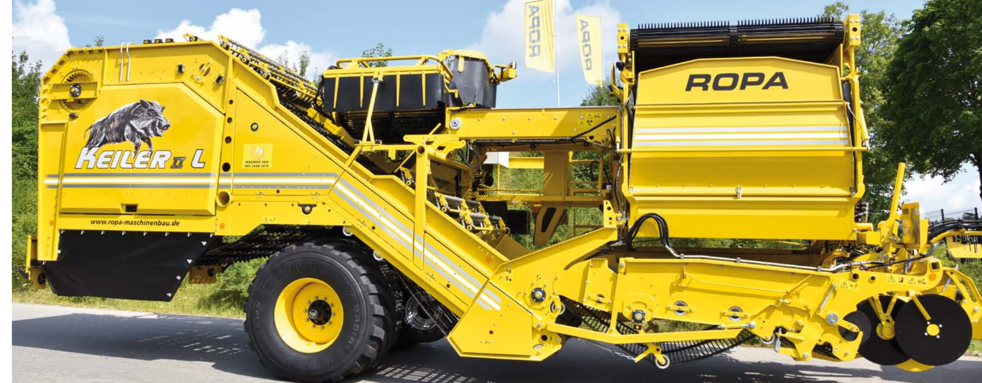
Keiler 2 L 4- ježková separace bez odpadní šachty a přebírací plošiny vpravo
