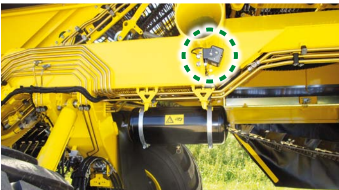
Přídavné kamery pro prosévací pás, vynášec natě, ježek, přebírací pás, zásobník a pro zpětný chod stroje
