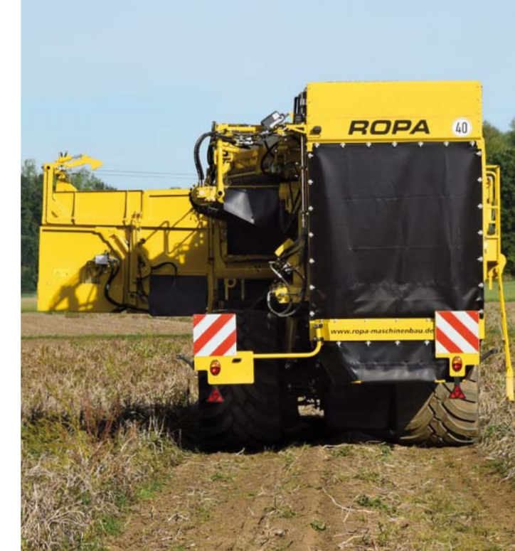
Vyorávání kolejových řádků se zasunutou teleskopickou nápravou - bez jízdy po hrůbkách brambor
