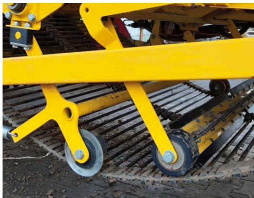
Upínač filtračního řetězu se zvláštním, výklopným čistícím válcem
