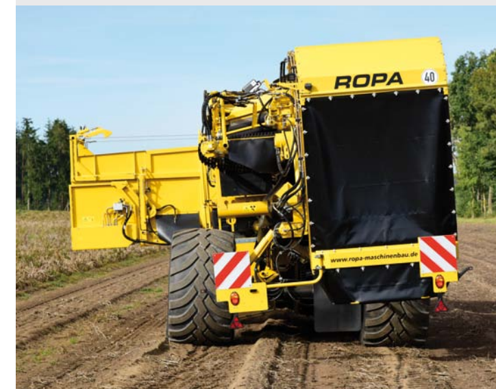
Standardní hydraulická kompenzace sklonu - optimalizované čištění a větší pohodlí pro přebírací personál
