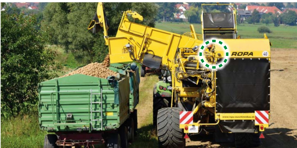
Přídavné kamery pro prosévací pás, vynášec natě, ježek, přebírací pás, zásobník a pro zpětný chod stroje
