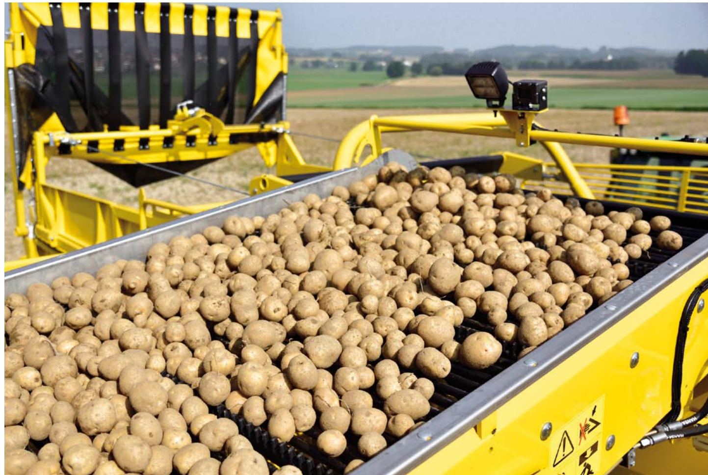
Přídavné kamery pro prosévací pás, vynášec natě, ježek, přebírací pás, zásobník a pro zpětný chod stroje
