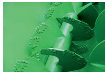
Hlavní míchací a řezací šnek.
