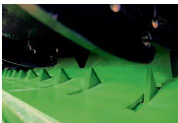
Volitelné protiostrí pro přesné řezání a plynulejší výkon při nakládce.
