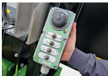
Mechanický rozvaděč s lanovody.
