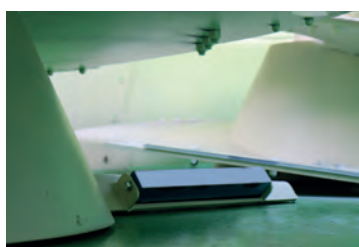
Na přání je k dispozici magnet na šnek, aby bylo možné odstranit nebezpečné materiály z TMR.
