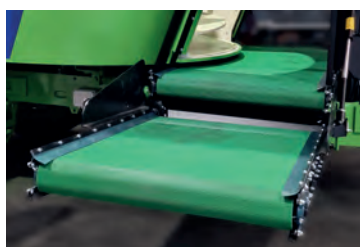
Hydraulické prodloužení oboustranného pásu.
