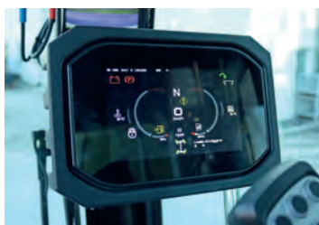
7" interaktivní barevný dotykový displej s integrovanou diagnostikou.
