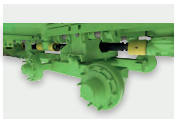
Kyvné nápravy umožňují optimální vyvážení zatížení.
