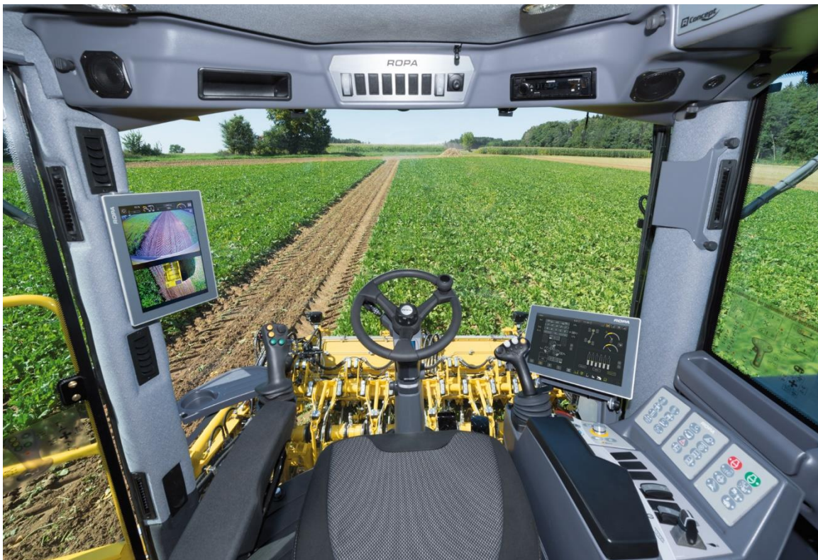
Obrázek 2- Kabina s novým interiérem a dvojicí velkých 12,1palcových displejů
