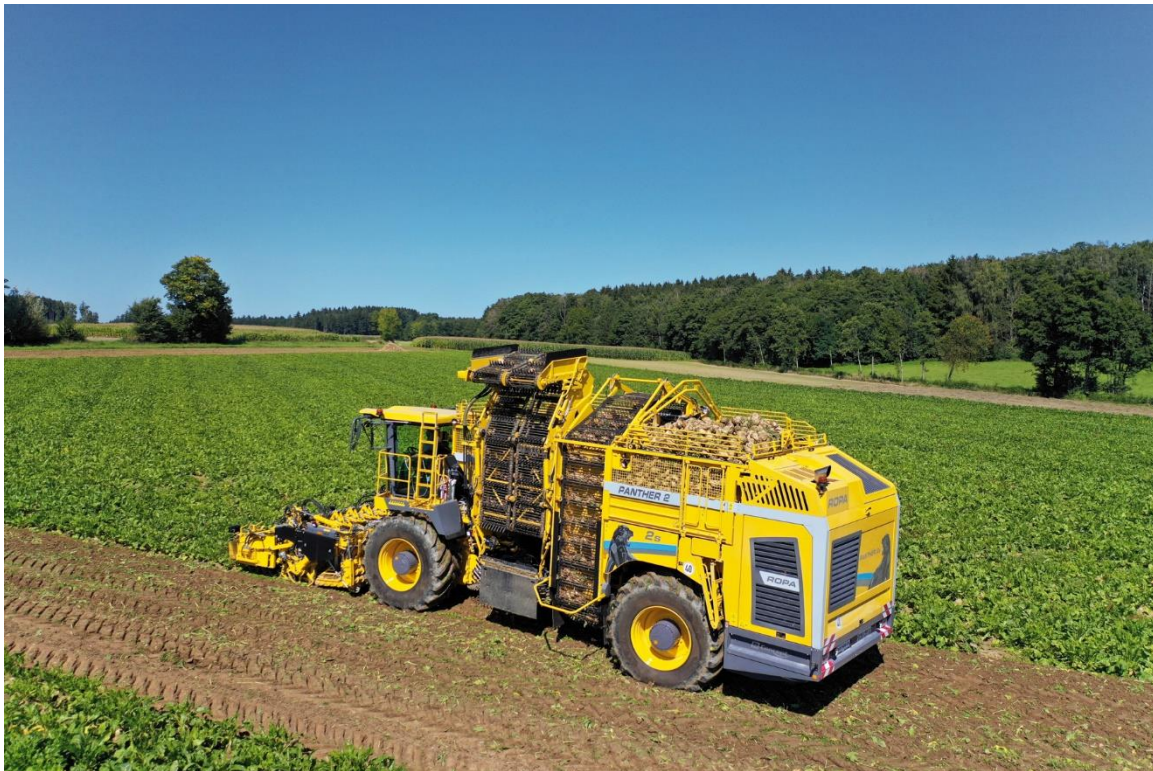
Obrázek 3- Extra dlouhý vyprazdňovací dopravník pro efektivní vyprazdňování za jízdy
